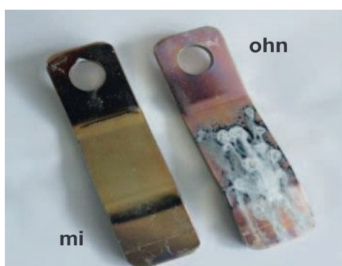
TOPAS 3100 + PROSEALXZ 111 (+ PROSEAL Nanoadditiv) + SURFASEAL WL150 după 840 h conform DIN EN ISO 9227
