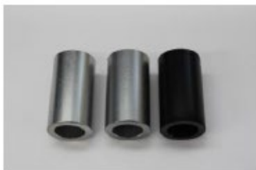
Acoperire de protecție cu SURFASEAL WL 300
